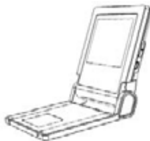
Рис. 1. Неправильная установка прибора
