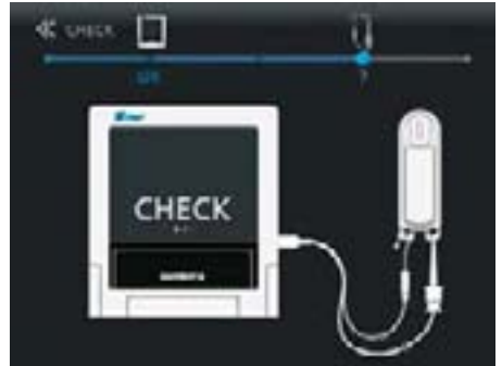
Şekil 33 Kontrol fişindeki eğe klipsleri + dudak klipsinin bağlantısı
