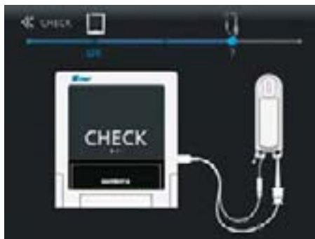
Fig. 33 Tilslutning af fil- + læbeclips til teststik
